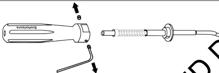
2. Mantenga el botón apretado, retire completamente la punta deslizándola. Después retire por completo los tornillos y guárdelos.
