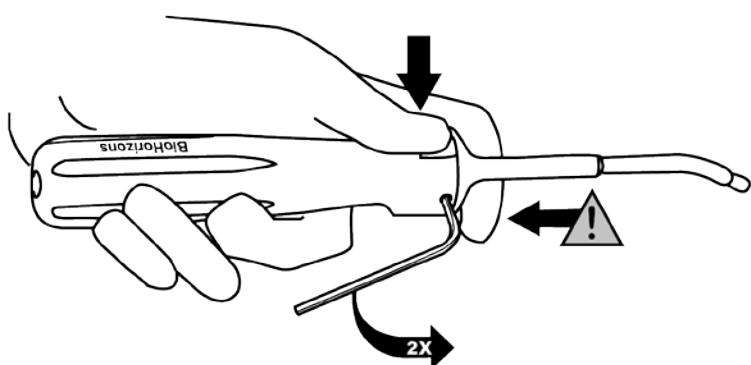
1. Para separar la punta del mango, mantenga el dedo sobre la base como indicado, apriete el botón y suavemente afloje los tornillos con dos vueltas enteras utilizando la llave hexagonal 5/64.
