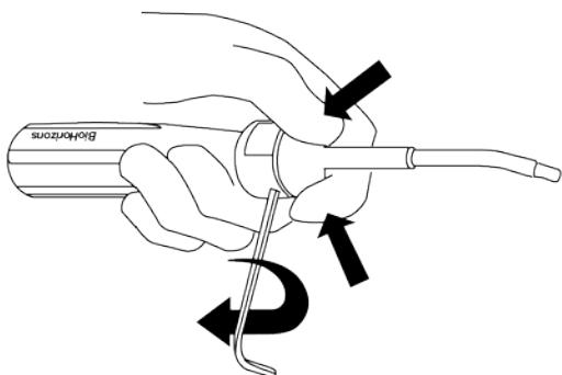
6. Halten Sie den Stutzen mit einer Hand fest gegen den Handgriff und ziehen Sie mit der anderen Hand die Handgriffschrauben handfest mit 5/16" Innensechskantschlüssels.
