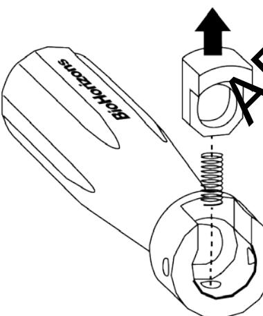
4. Knopffeder vorsichtig in die kleine Federbohrung im Handgriff einsetzen. Setzen Sie den Knopf auf die Knopffeder auf, so dass die Aussparung gegen das Auslöserende des Handgriffs zeigt. Knopf nach unten drücken, bis er vollständig aufsitzt, und für die Endmontage an Ort und Stelle festhalten.
