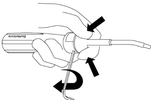
6. Mantenga la punta firmemente contra el mango con una mano y con la otra apriete los tornillos. Apriete fuerte usando la llave hexagonal de 5/64".
