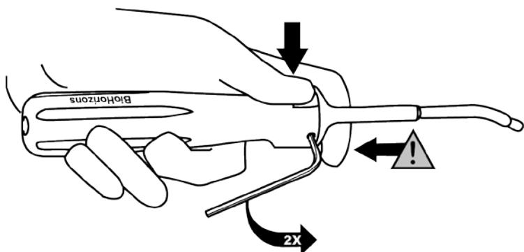
1. Pour détacher l'embout de la poignée, maintenir la collerette de l'embout comme indiqué, appuyer de manière continue sur le bouton, puis dévisser lentement les deux vis de la poignée d'environ deux tours complets à l'aide d'une clé Allen 5/64".
