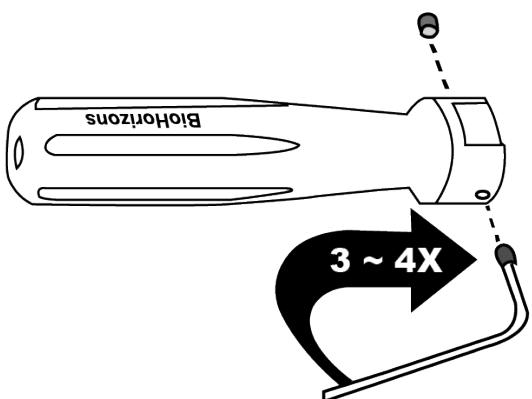
2. Die Handgriffschrauben mit 3-4 vollen Drehungen in den Handgriff vermontieren.
