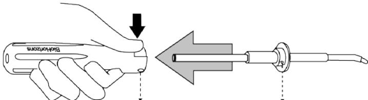
5. Inserte el ensamblaje de la punta a través el agujero del botón dentro del mango asegurándose que los agujeros de los tornillos del mango y de la punta estén alineados y que la angulación de la punta esté alejada del botón de disparo (Véase paso 7 para el ensamblaje final del mango).
