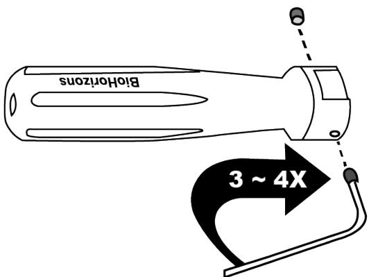
2. Pré-assembler les vis de la poignée dans la poignée, en appliquant 3 à 4 rotations complètes.
