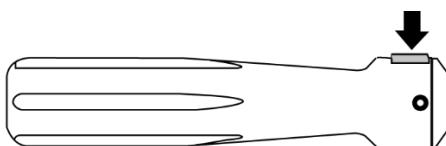
7. Un ensamblaje correcto del mango tendrá la punta inclinada en dirección opuesta al botón, como mostrado a continuación. Verifique que el ensamblaje sea correcto haciendo una carga/disparo con el mango montado.
