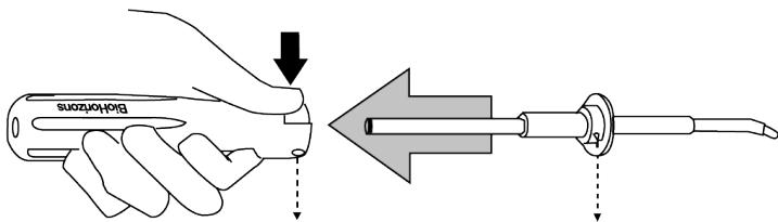
5. Inserte el ensamblaje de la punta a través el agujero del botón dentro del mango asegurándose que los agujeros de los tornillos del mango y de la punta estén alineados y que la angulación de la punta esté alejada del botón de disparo (**Véase paso 7 para el ensamblaje final del mango**).
