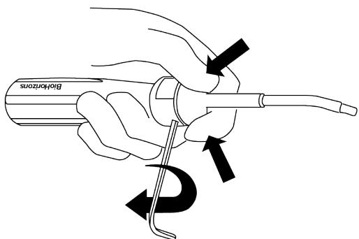
6. Maintenir fermement l'embout contre la poignée d'une main et utiliser la main libre pour visser les vis de la poignée. Serrer les vis à la main à l'aide d'une clé Allen 5/64".
