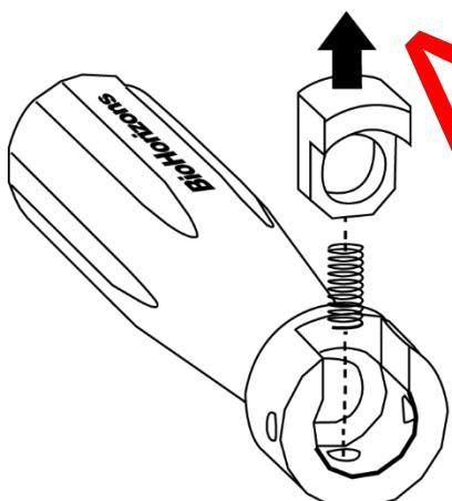
4. Placer avec soin le ressort du bouton dans le petit orifice de ressort de la poignée. Placer le bouton par-dessus le ressort de bouton, l'encoche découpée faisant face à l'extrémité d'amorçage de la poignée. Appuyer sur le bouton jusqu'à ce qu'il soit complètement en place, et le maintenir en position pour le montage final.
