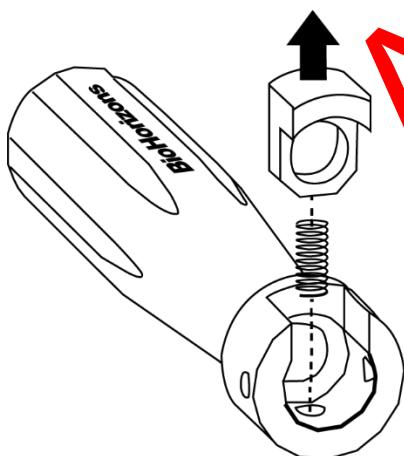
4. Coloque cuidadosamente el muelle del botón en el pequeño agujero del mango. Coloque el botón sobre el muelle con la parte prominente orientado hacia la punta. Apriete el botón suavemente hasta que se sitúe bien en la posición final para el ensamblaje.
