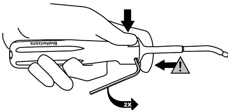
1. Um den Stutzen aus dem Handgriff zu lösen, halten Sie den Stutzenflansch wie in der Abbildung gezeigt, drücken Sie auf den Knopf und lösen Sie sorgfältig die beiden Handgriffschrauben um ca. zwei volle Drehungen mithilfe 5/64“ Innensechskantschlüssel.
