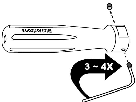
2. Die Handgriffschrauben mit 3-4 vollen Drehungen in den Handgriff montieren.
