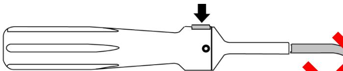
Bei korrekt montiertem Handgriff zeigt der Stutzen nach unten weg, wenn sich der Auslöseknopf oben befindet (s. Abbildung). Überprüfen Sie den korrekten Zusammenbau, indem Sie einen einzelnen Lade/Auslösezyklus mit dem Handgriff durchführen.
