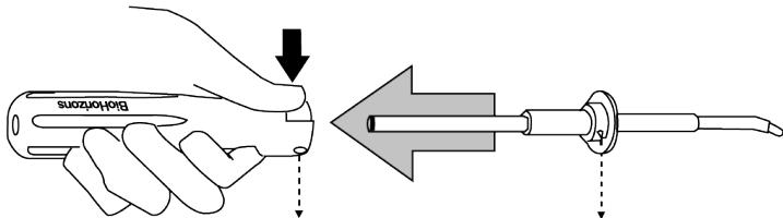
5. Insérer l'ensemble d'embout dans l'orifice du bouton, puis dans la poignée, en s'assurant que les orifices de vis de la poignée et de l'embout sont alignées et que l'extrémité de l'embout ne se trouve pas du même côté que le bouton d'amorçage (voir l'étape 7 présentant la poignée montée).
