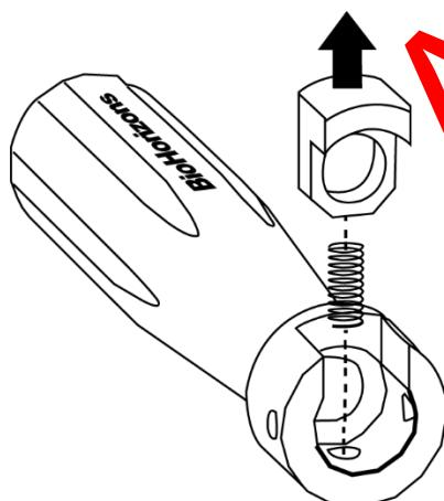
4. Knopffeder vorsichtig in die kleine Federbohrung im Handgriff einsetzen. Setzen Sie den Knopf auf die Knopffeder auf, so dass die Aussparung gegen das Auslöserende des Handgriffs zeigt. Knopf nach unten drücken, bis er vollständig aufsitzt, und für die Endmontage an Ort und Stelle festhalten.
