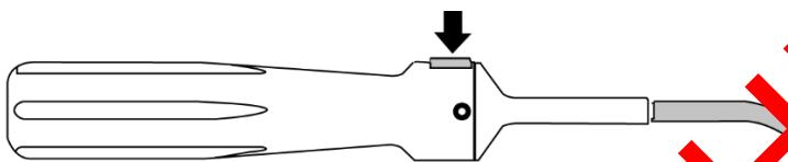
Sur une poignée correctement montée, l'extrémité de l'embout ne doit pas être dirigée du même côté que le bouton (en haut) de la poignée, comme indiqué ci-dessous. Vérifier que le montage est correct en réalisant un seul cycle de chargement/d'amorçage avec la poignée.
